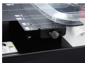
Der Heftanschlag lässt sich stufenlos von 3 bis zu 23 mm einstellen und durch diesen Drehknopf arretieren.
